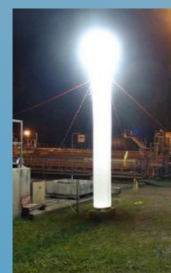
Промышленные Световые Башни (надувной фонарь) с генератором
