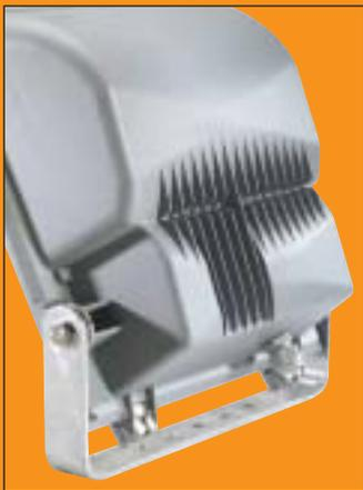
Robustes LM6 Aluminiumdruckgussgehäuse (3mm) Korrosionsgeschützt. Metallicgraue Polyesterbeschichtung (RAL 9006). Rückwärtige Kühlrippen zur Erhaltung der Betriebstemperatur  $t_a$  40°C. Eine Stahlplatte trennt Lampe und Anschlussraum
