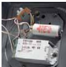
Блок ПРА на полностью съемной панели
