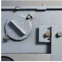
Узел замены лампы и шкала установки угла
