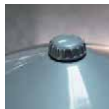
Крепление крышки оптического отсека
