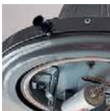
Стопор, предотвращающий отворачивание рассеивателя
